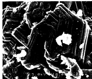
NiS の SEM 像 (2) ( 240^\circ C - 10 h \cdot 3\mu m の微粉末)
