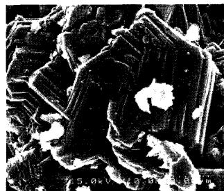
NiS の SEM 像 (2) (240 °C - 10 h · 3 μm の微粉末)
