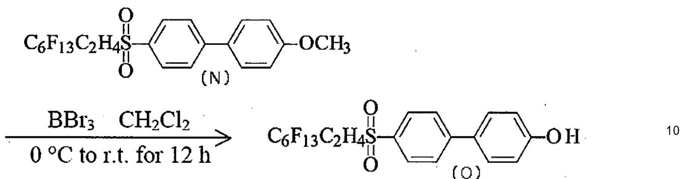
化合物 N (2.00g, 3.37mmol)、三臭化ホウ素 (2.60g, 10.38mmol) とジクロロメタン 50mL を 200 mL のナスフラスコに入れて氷浴中で 2 時間攪拌した。徐々に室温に戻してさらに 12 時間攪拌した。その後、氷浴中で水を加えて 1 時間攪拌した後に分液漏斗に移した。そこへエーテルを加えて有機層と水層に分離した。得られた有機層に無水硫酸マグネシウムを加えて 1 時間放置した後、有機層をひだ折り濾過して濾液をエバポレーターで濃縮すると化合物 O が得られた。
