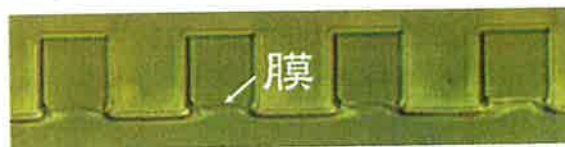
図 4: マイクロチャンバの出口付近に脂質膜を形成した様子。接触法を応用し、水、有機溶媒、水を交互に流すことよって、安定して大量に膜を形成できることがわかった。
