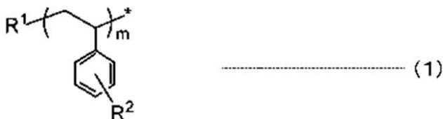
ここで、上記一般式(1)中、R<sup>1</sup>はラジカル重合開始剤残基、R<sup>2</sup>は水素原子、アルキル基、アール基及びハロゲン基のいずれかを表す。は下記一般式(2)で示されるポリマーとの結合部位を示す。mは重合度で、80~1500の整数である。
