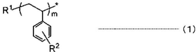
ここで、上記一般式(1)中、 $R^1$ はラジカル重合開始剤残基、 $R^2$ は水素原子、アルキル基、アリアル基及びハロゲン基のいずれかを表す。は下記一般式(2)で示されるポリマーとの結合部位を示す。 $m$ は重合度で、80~1500の整数である。
