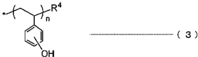
ここで、上記一般式(3)中、R<sup>4</sup>は精密ラジカル重合の重合制御剤残基もしくはその酸加水分解残基を表す。は上記一般式(1)で示されるポリマーとの結合部位を示す。nは重合度で、50～1500の整数である。
