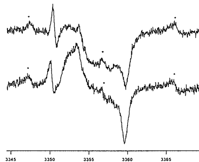
図1. C1027 蛋白複合体で観測された w-band EPR スペクトル (マイクロ波強度 0.05 (a) および 0.0025mW (b), *は、Mn 由来の信号)
