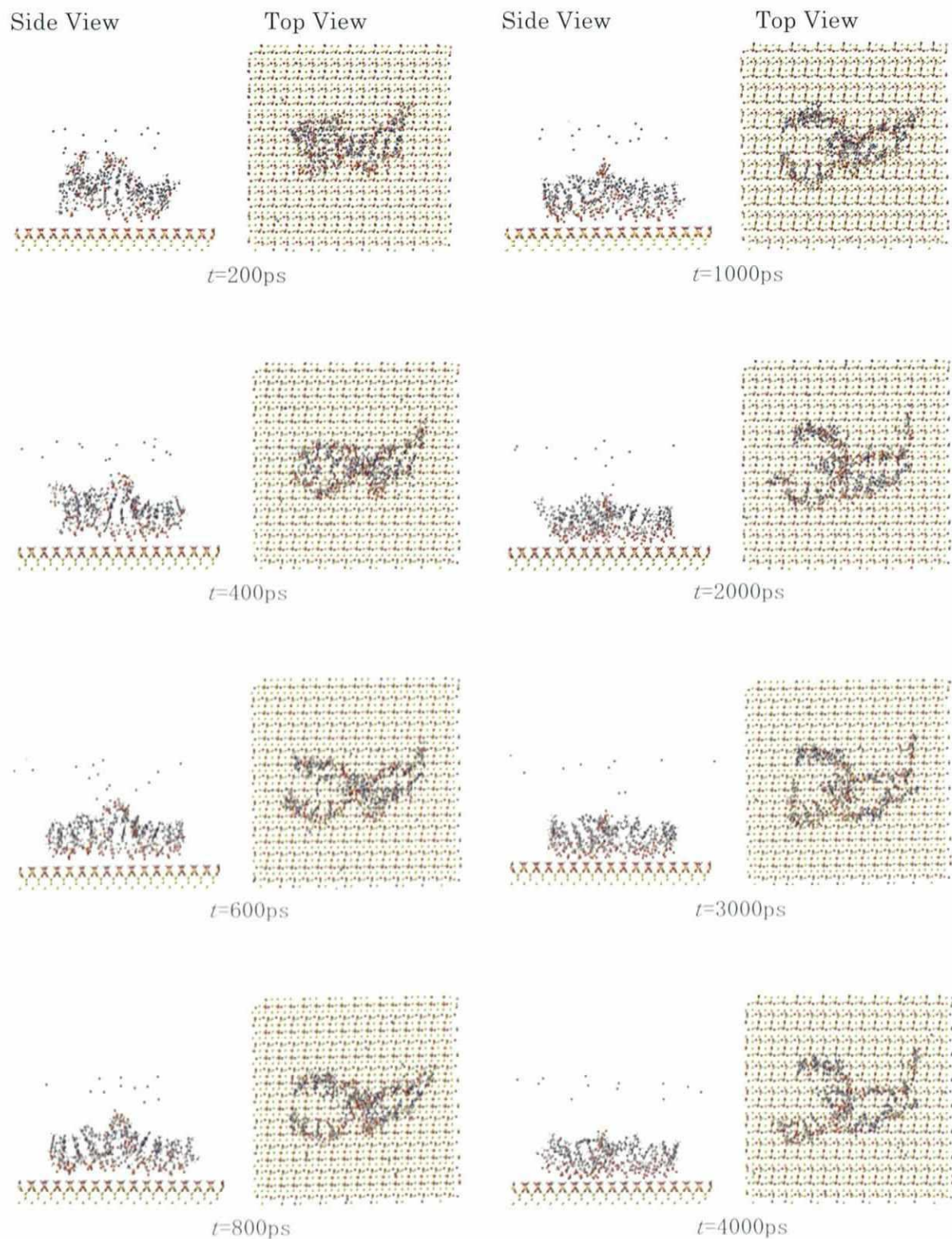
図2 SiO 2 基板近傍における10bp poly(dA)・poly(dT) DNAの流動と固着の分子動力学シミュレーション
