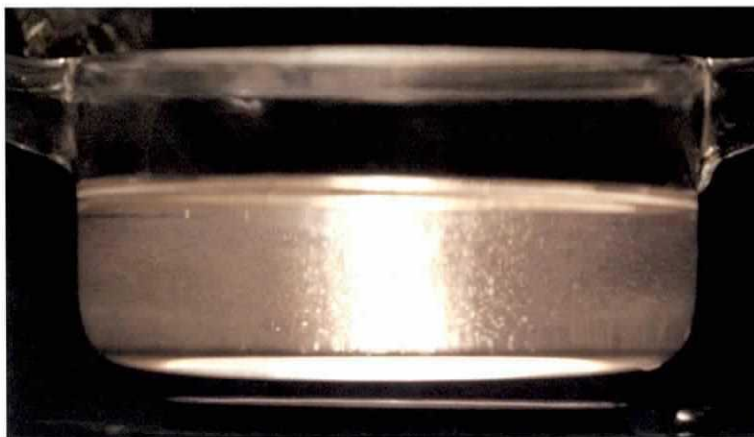
図5 新規可視光応答型光触媒による水分解の実験
