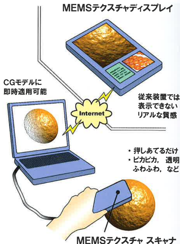
図1. 実際の物体の表面に押し当てるだけでテクスチャ(質感)情報を取り込んで、コンピュータグラフィックス(CG)に適用できるシステムです。最終的には質感ディスプレイも開発して総合的なテクスチャシステムをめざしています。
